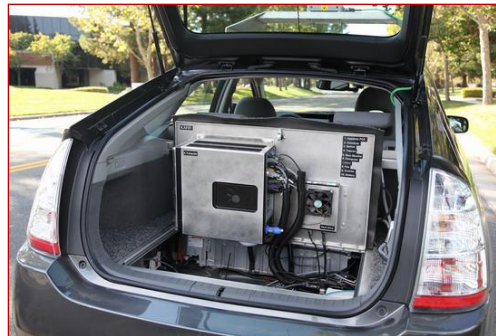
Figura 14: Sistema computarizado en el maletero del vehículo.
